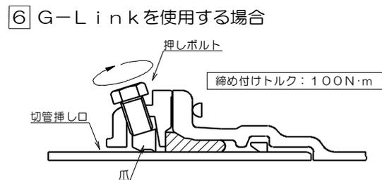
判定基準 ※ 受口端面と押輪またはG-Linkの施工管理用突部との間に0.5mm以上の隙間がないこと。
