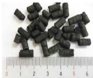
(左)下水汚泥固形燃料化施設と(右)燃料化物(炭化固形物)
