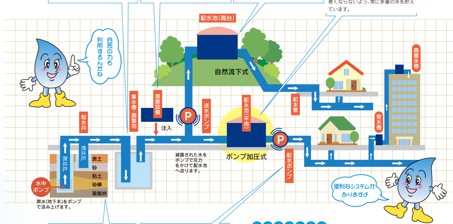
集水槽・調整池 汲み上げた水を一旦ここに集めます。 滅菌設備 次亜塩素酸ナトリウムで滅菌します。 配水池(高台) 配水池(平地) 水使用が集中する時間帯でも水の出が悪くならないよう、常に多量の水を貯えています。
