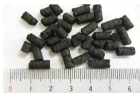
(左)下水汚泥固形燃料化施設と(右)燃料化物(炭化固形物)
