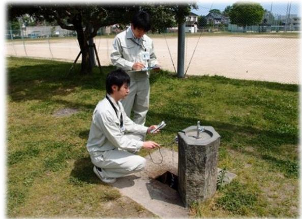
水質検査（給水栓水）の様子
