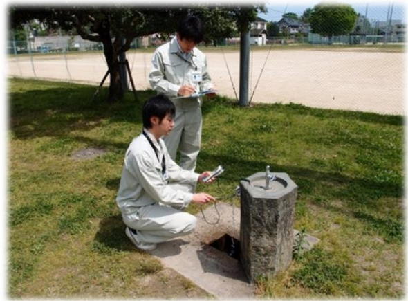
水質検査（給水栓水）の様子
