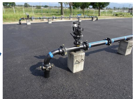
研修管(B) 配水管継手施工研修
