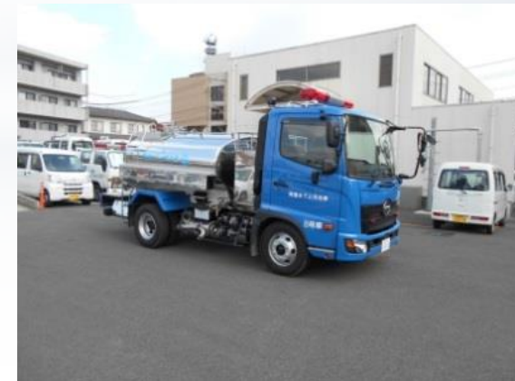
給水車 (応急給水)
