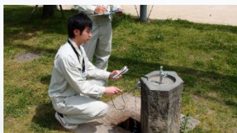
給水栓の水質検査
