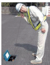
漏水調査（音聴棒）
