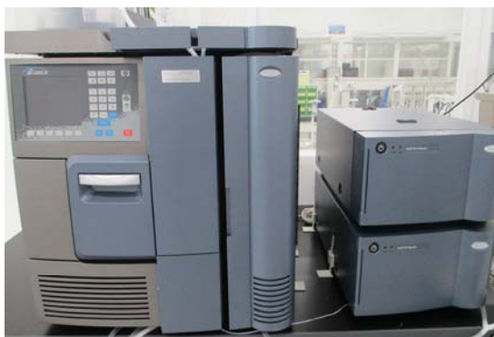
高速液体クロマトグラフ (ウォータースコーポレーション製e2695)
