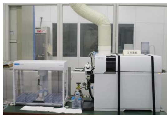
誘導結合プラズマ質量分析装置 (アジレントテクノロジー製Agilent 7800 ICP-MS)
