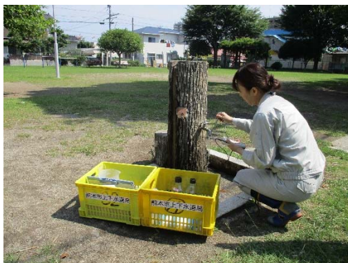
給水栓水採水
