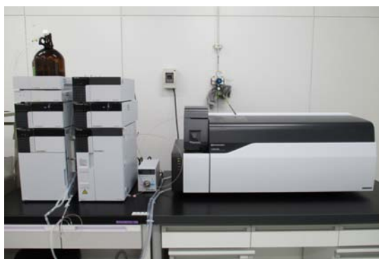
液体クロマトグラフ-タンデム型質量分析計 (島津製作所製LCMS-8050)
