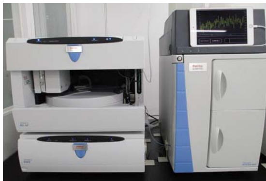
イオンクロマトグラフ (サーモフィッシャーサイエンティフィック製 Dionex Integrion)
