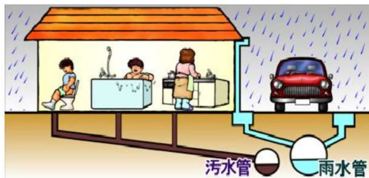
▲分流式下水道のイメージ
