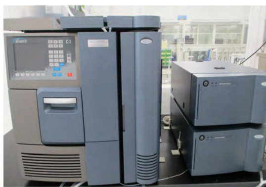
高速液体クロマトグラフ (ウォータースコーポレーション製e2695)
