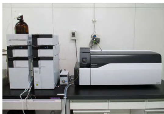
液体クロマトグラフ-タンデム型質量分析計 (島津製作所製LCMS-8050)
