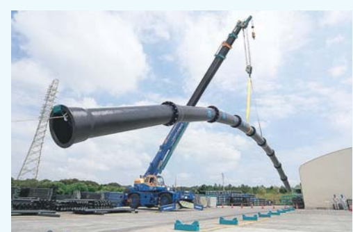
力が加わって、たわんでも折れたり、継ぎ手が抜けたりしない「ダクタイル鉄管」(写真提供/日本ダクタイル鉄管協会)
